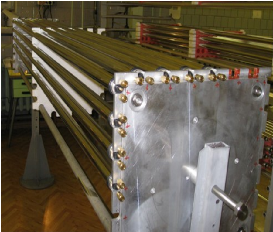
Стенд «выдержки» ДТ при вклейке заглушек
