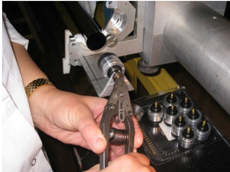
Фиксация (обжим) проволоки в капиллярной трубке
