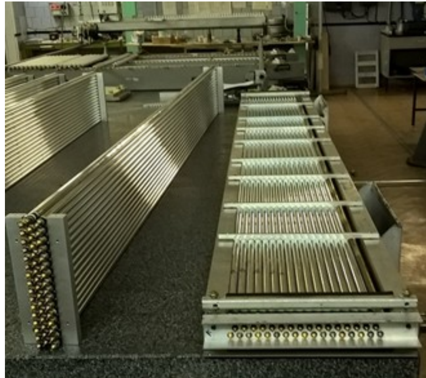
48 шт. 15-мм ДТ в монтажной кассете
