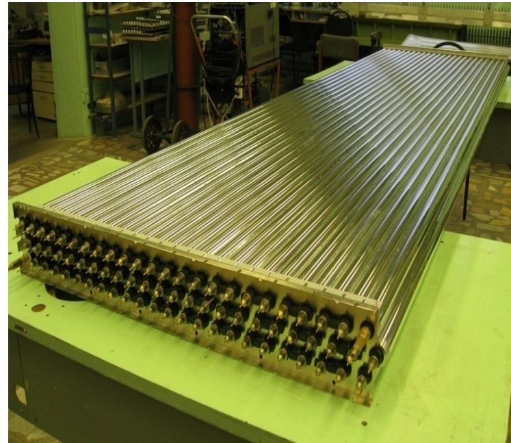
Склеенные 3-слойные модули из 30-мм ДТ
